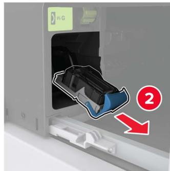
**3** Entfernen Sie die losen Heftklammern.
