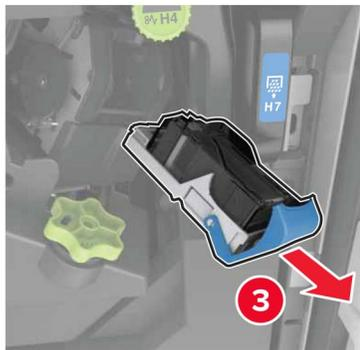
**3** Entfernen Sie die losen Heftklammern.
