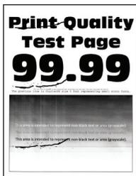
**Hinweis:** Drucken Sie die Seiten für Druckqualitätstests aus, bevor Sie das Problem beheben. Gehen Sie an der Bedieneinheit zu **Einstellungen > Fehlersuche > Seiten für Druckqualitätstests ausdrucken**.
